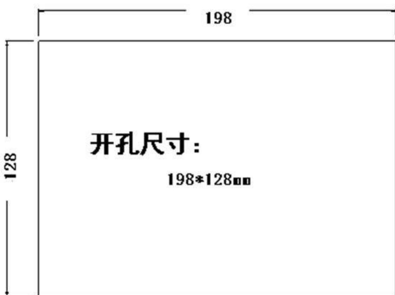
安装触摸屏的开孔尺寸为：198mm x 128mm
